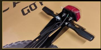
**INSTALL BRAKE LIGHT** - INSTALL INDICATORS \* ENSURE THE LH AND RH INDICATORS ARE FIXED TO THE MOUNT ACCORDINGLY AND THAT THE CLEAR PLASTIC SECTION OF THE BRAKE LIGHT IS FACING THE NUMBER PLATE \*
